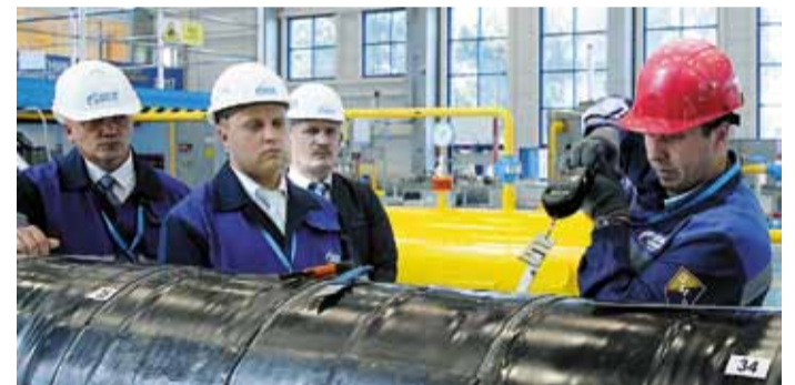
Этап – «Оценка уровня адгезии изоляционного материала»
